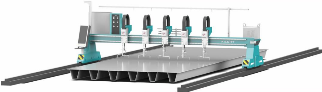
Станок для правки нижней пластины П-образных ребер (горячая правка)
